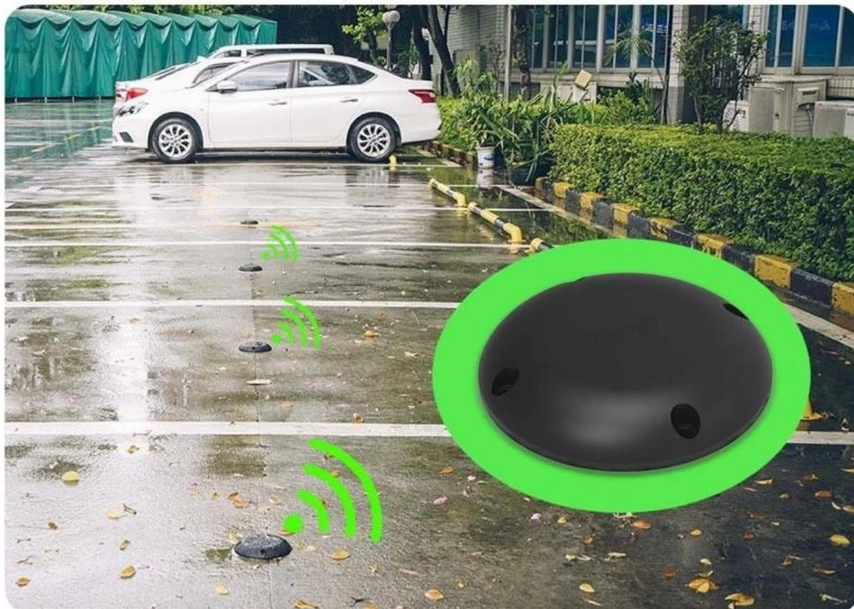
Sensores de estacionamento geomagnéticos são usados principalmente para detecção de veículos em vagas de estacionamento e vagas de estacionamento. O sensor de estacionamento está equipado com sensores geomagnéticos, sensores de microondas 24G e módulo de comunicação de redes, comunicação Bluetooth e outras funções podem detectar com eficácia veículos estacionados acima do dispositivo e carregar os resultados da detecção para o servidor em nuvem através da rede.
