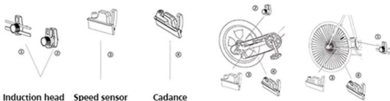
1. Coloque el sensor de velocidad en el interior del tubo de la horquilla trasera, use primero el arreglo del cable
