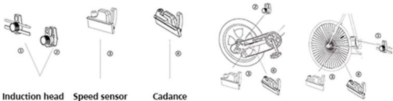
1. Stellen Sie den Geschwindigkeitssensor in das hintere Gabelrohr, verwenden Sie zuerst das Kabel.
